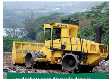
Les déchets sont déversés dans le casier étanche puis compactés à l'aide d'un engin spécialisé, de manière à réduire leur volume et pour minimiser les odeurs.
