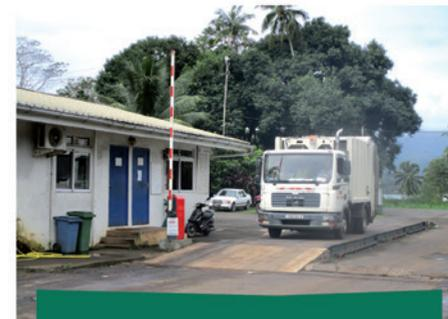
Tous les camions sont pesés sur le pont à bascule en entrée et en sortie.
